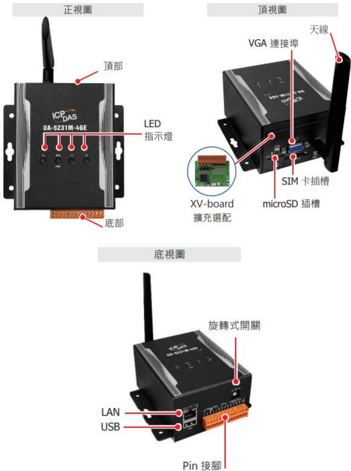
圖 4) 機構圖 UA-5231M 3G/4G 系列
