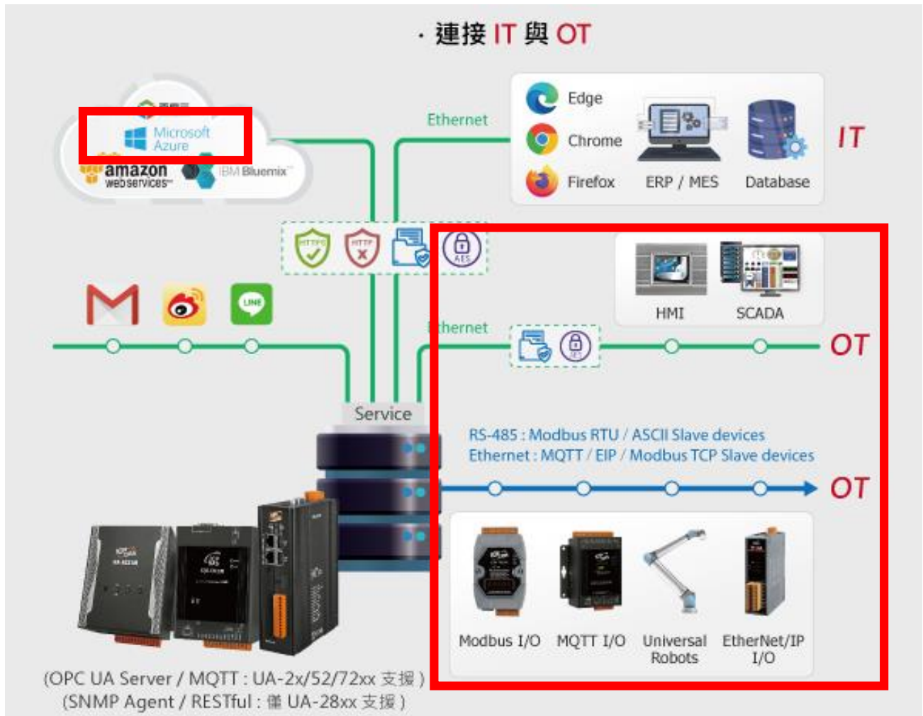
圖 146) MQTT 連線 Microsoft Azure 平台應用圖
