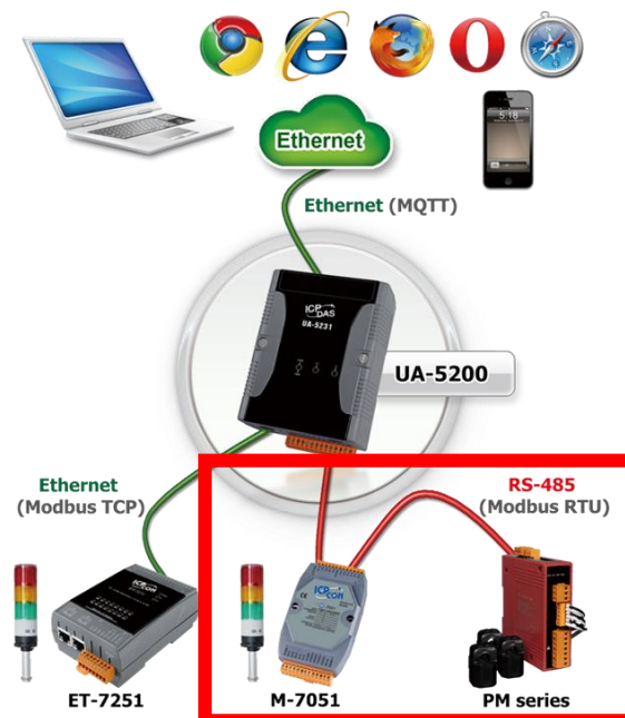
圖 194) MQTT JSON 和 Modbus 轉換功能應用方案架構圖
