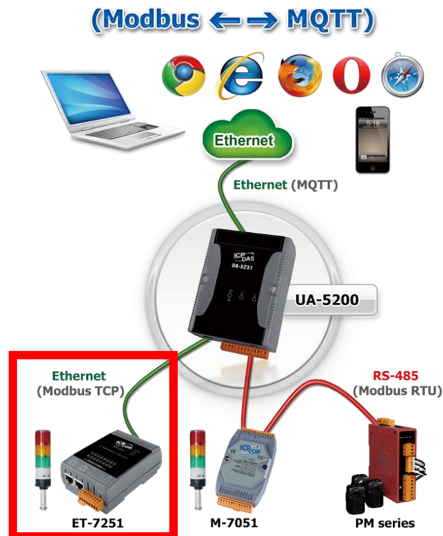
圖 184) MQTT 和 Modbus TCP 轉換功能應用方案架構圖
