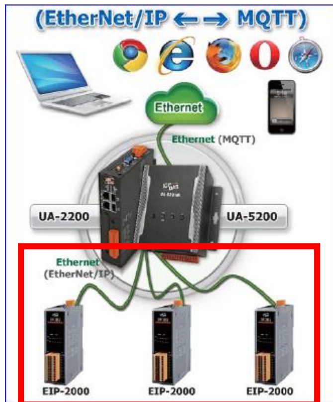
圖 189) MQTT 和 EtherNet/IP 轉換功能應用方案架構圖
