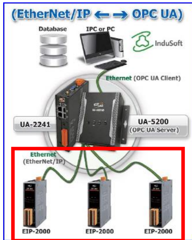
圖 170) OPC UA 和 EtherNet/IP 轉換功能應用方案架構圖
