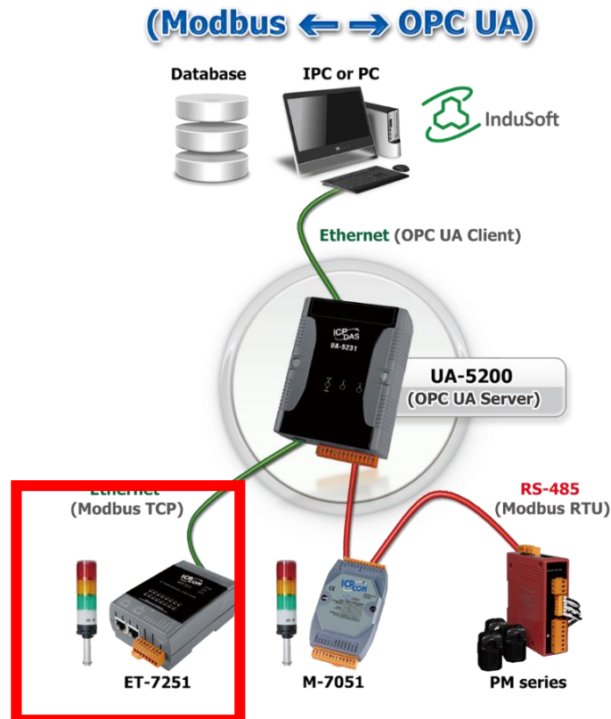
圖 162) OPC UA 和 Modbus TCP 轉換功能應用方案架構圖
