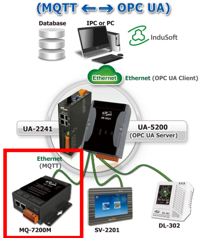
圖 166) OPC UA 和 MQTT 轉換功能應用方案架構圖
